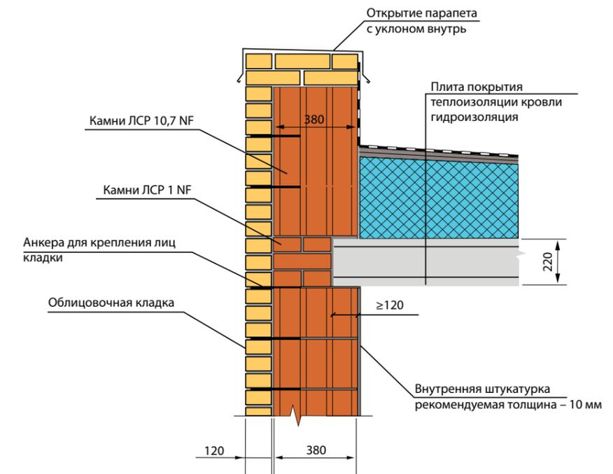
Плоская кровля с совмещенным покрытием по пустотной ж/б плите, стена из крупноформатных камней ЛСР 0,7 НФ (380 мм) с облицовкой кирпичом ЛСР (120 мм)
