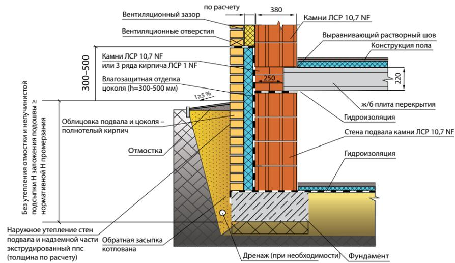
Наружная стена подвала из крупноформатных камней ЛСР 10,7 НФ (380 мм), пустотная ж/б плита перекрытия, наружная стена из крупноформатных камней
