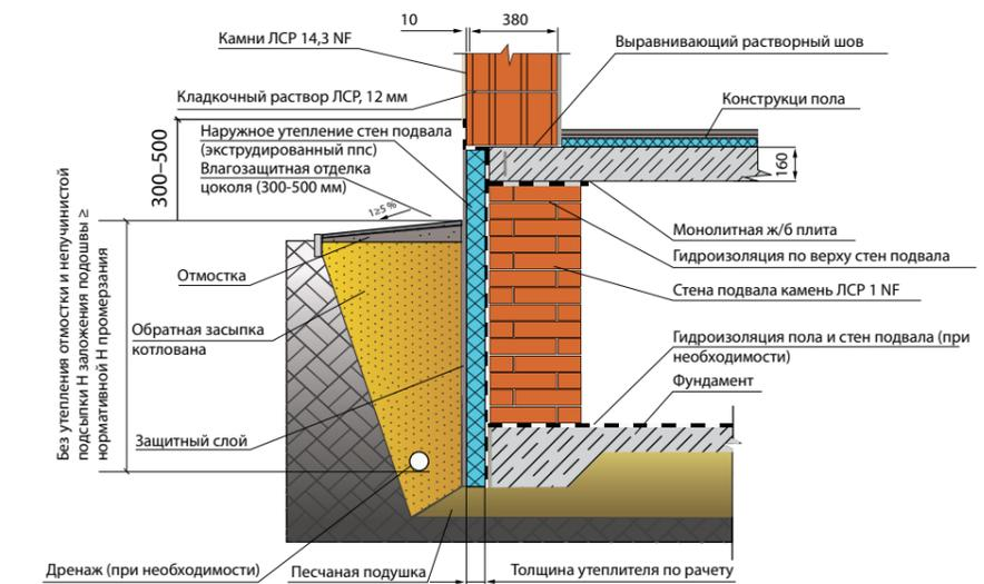
Наружная стена подвала из крупноформатных камней ЛСР 1 НФ (380), монолитное ж/б перекрытие, наружная стена из крупноформатных камней ЛСР 10,7 НФ (380 мм) с наружной штукатуркой
