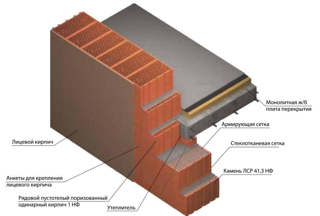
Опирание монолитной ж/б плиты на стену из крупноформатных камней ЛСР 14,3 НФ (510 мм) со штукатуркой
