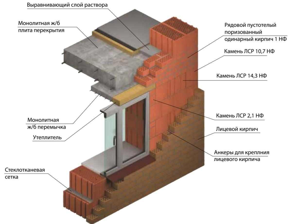
Устройство оконного проема. Опираение монолитной ж/б плиты на стену из крупноформатных камней ЛСР 14,3 НФ (510 мм) с облицовкой кирпичом ЛСР (120 мм)
