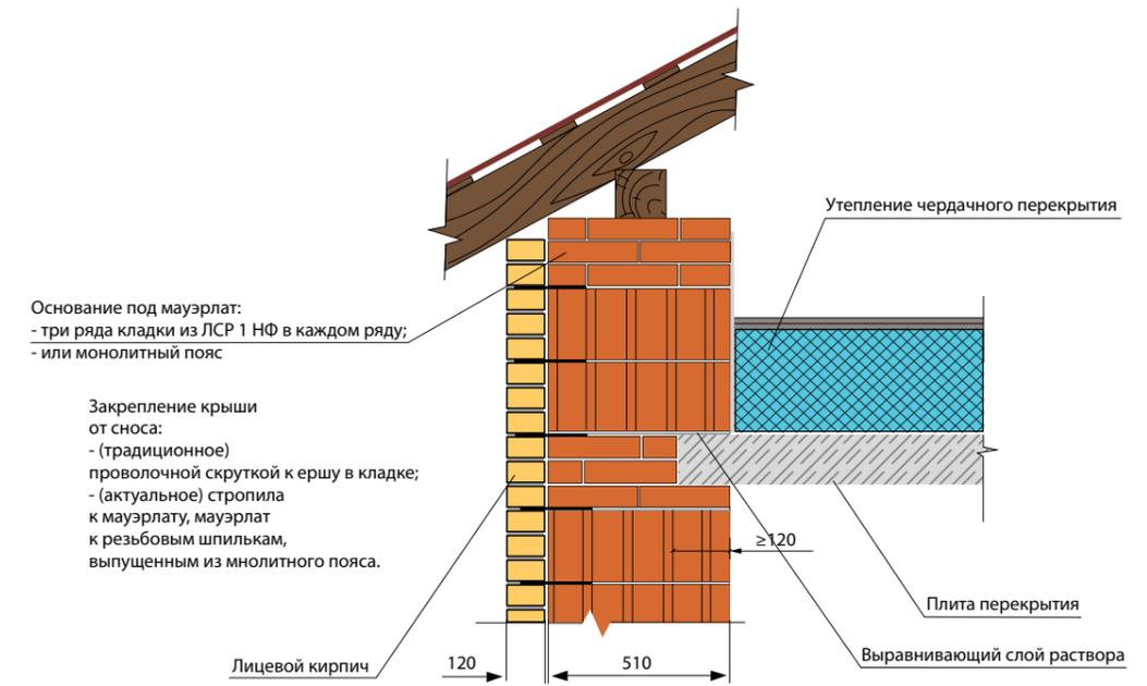
Скатная крыша с холодным чердаком, наружная стена из крупноформатных камней ЛСР 14,3 НФ (510 мм) облицовкой кирпичом ЛСР (120 мм)
