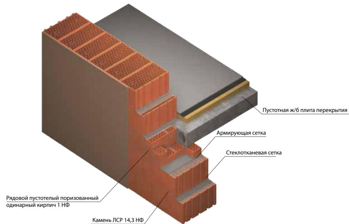
Опирание монолитной ж/б плиты на стену из крупноформатных камней ЛСР 14,3 НФ (510 мм) со штукатуркой
