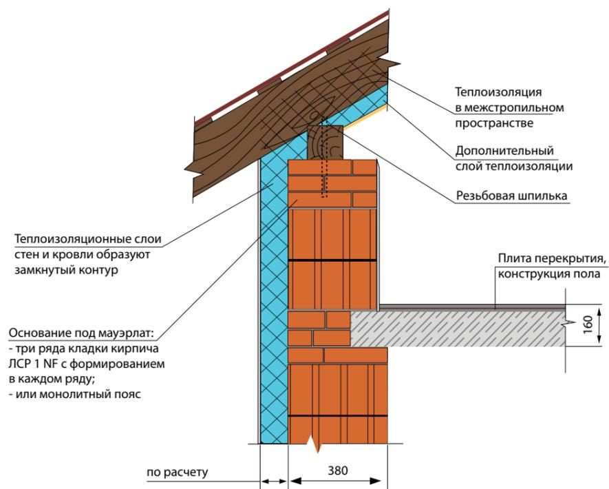
Скатная мансардная крыша, наружная стена из крупноформатных камней ЛСР 1НФ (380 мм) с наружным утеплением и штукатуркой
