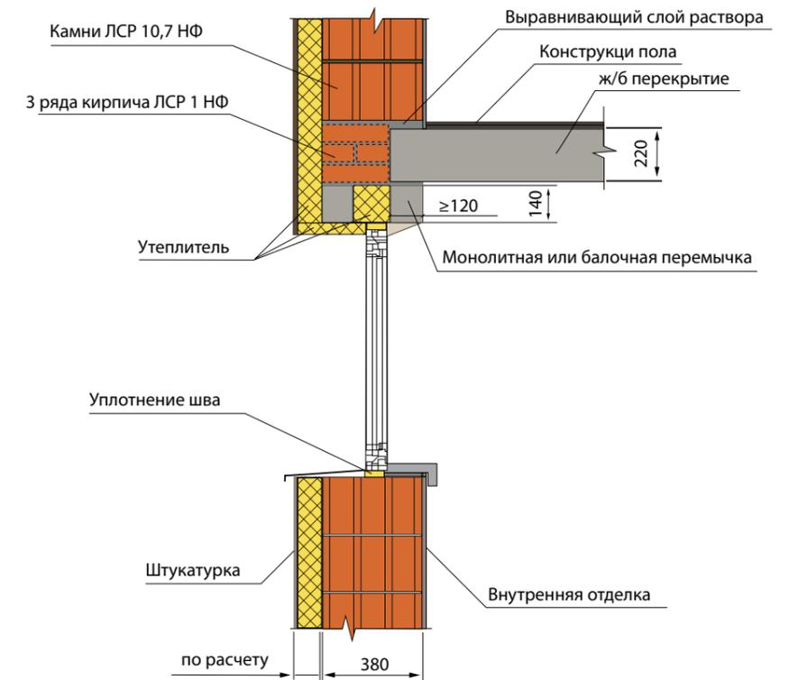
Устройство ж/б перемычки над проемом, наружная стена из крупноформатных камней ЛСР 10,7 НФ (380 мм) с утеплением и штукатуркой
