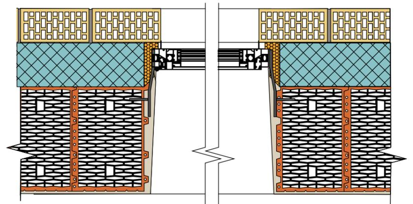
Установка окна в стену с наружным утеплением.
