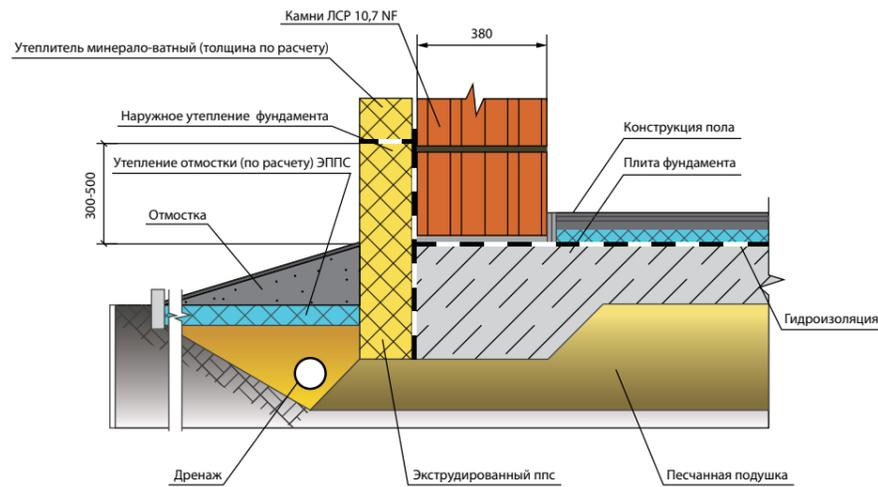
Мелкозаглубленный утепленный фундамент отапливаемого дома в виде ребристой плиты, стена из крупноформатных камней ЛСР 10,7 НФ (380 мм) с утеплением и наружной штукатуркой
