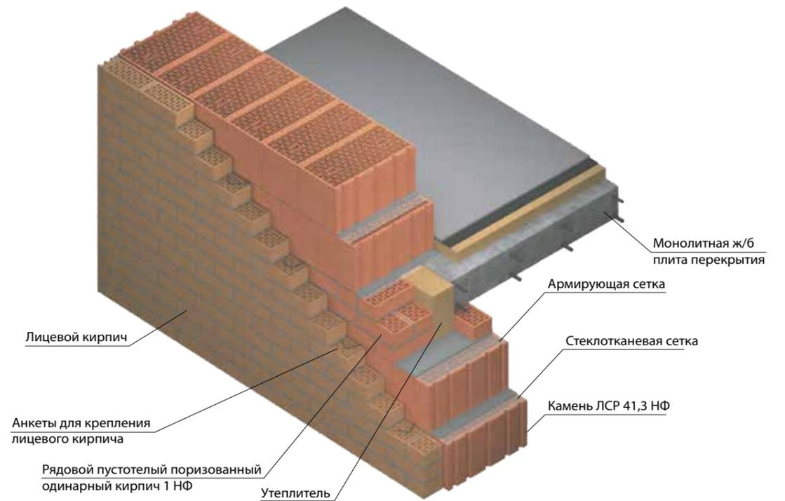
Опираие монолитной ж/б плиты на стену из крупноформатных камней ЛСР 14,3 НФ (510 мм) с облицовкой кирпичом ЛСР (120 мм)
