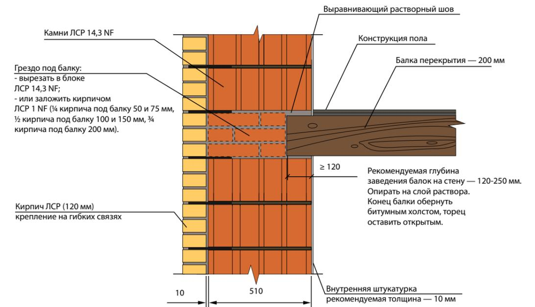
Перекрытие по деревянным балкам, наружная стена из крупноформатных камней ЛСР 14,3 НФ (510 мм) + облицовка кирпичом ЛСР (120 мм)
