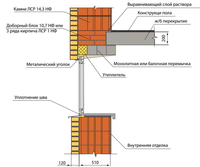
Устройство ж/б перемычки над проемом, наружная стена из крупноформатных камней ЛСР 14,3 НФ (510 мм) с облицовкой кирпичом ЛСР (120 мм)
