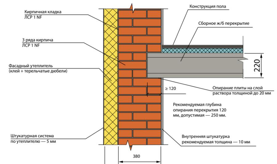
Пустотная плита перекрытия, наружная стена из крупноформатных камней ЛСР 1 НФ (380 мм) с утеплением и наружной штукатуркой
