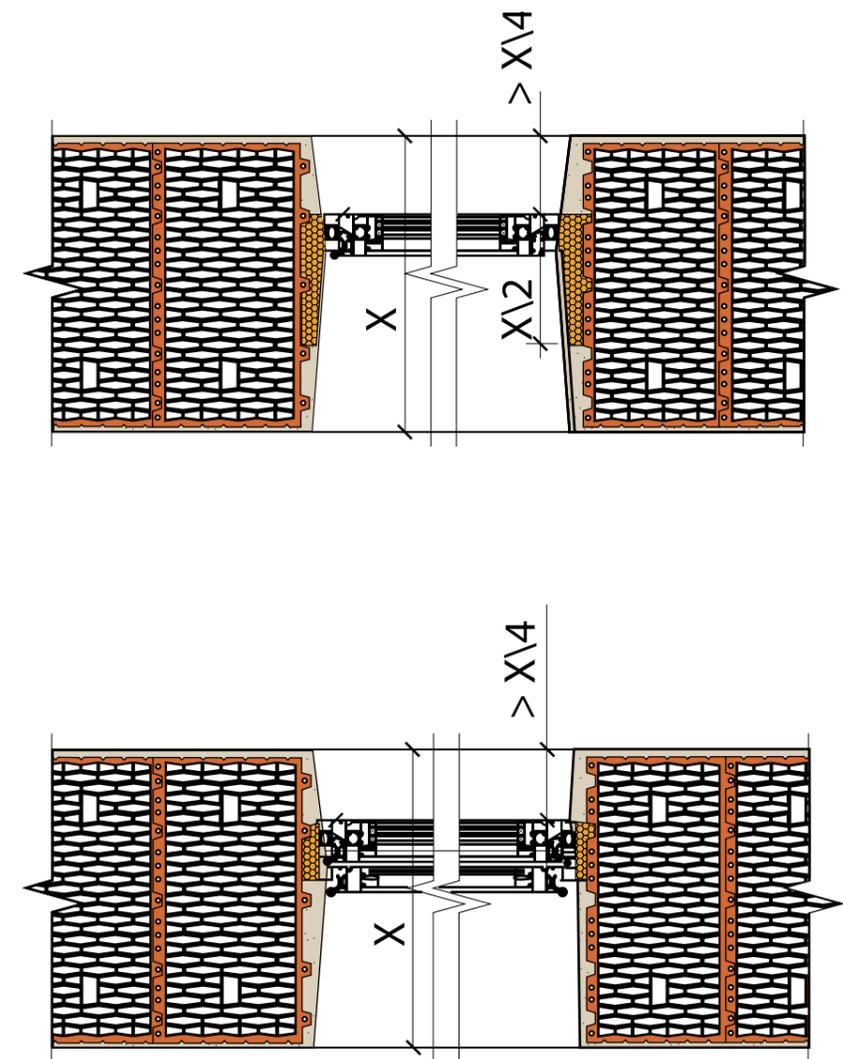
Установка окна в однородную оштукатуренную стену, оконная коробка шириной 80 мм и меньше. Установка окна в однородную оштукатуренную стену, оконная коробка шириной 130 мм и больше
