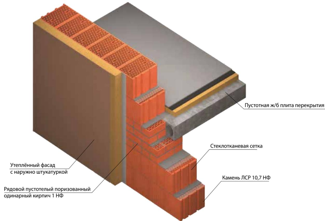
Опирание пустотной ж/б плиты на стену из крупноформатных камней ЛСР 10,7 НФ (380 мм) с утеплением и штукатуркой
