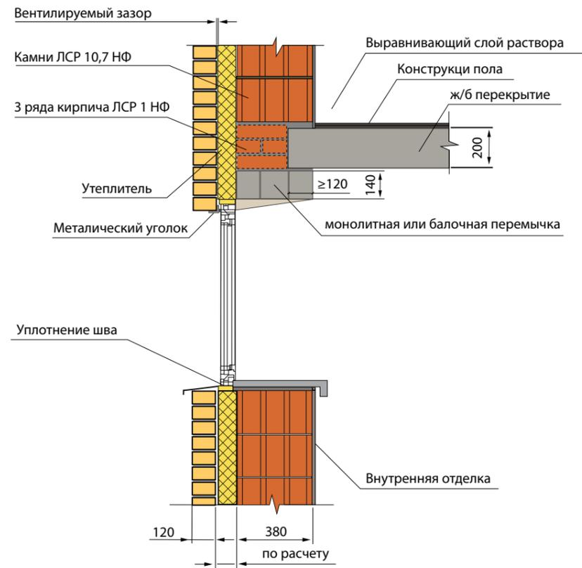
Устройство ж/б перемычки над проемом, наружная стена из крупноформатных камней ЛСР 10,7 НФ (380 мм) с утеплением и облицовкой кирпичом ЛСР (120 мм)
