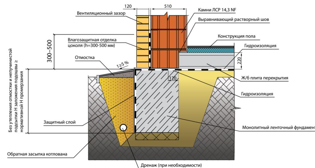
Монолитный ленточный фундамент, пустотная ж/б плита перекрытия, наружная стена из крупноформатных камней ЛСР 14,3 NF (510 мм) с облицовкой кирпичом ЛСР (120 мм)
