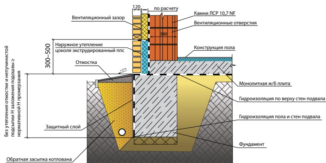
Монолитный ленточный фундамент, монолитный ж/б перекрытие, наружная стена из крупноформатных камней ЛСР 10,7 NF (380 мм) с утеплением и облицовкой кирпичом ЛСР (120 мм)
