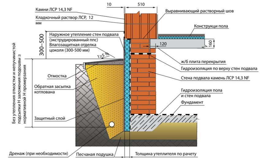
Наружная стена подвала из крупноформатных камней ЛСР 1 НФ (380), монолитное ж/б перекрытие, наружная стена из крупноформатных камней ЛСР 14,3 НФ (510 мм) с наружной штукатуркой
