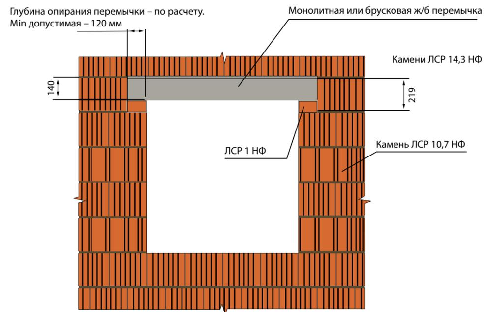
Устройство перемычек из крупноформатных камней ЛСР 14,3 НФ
