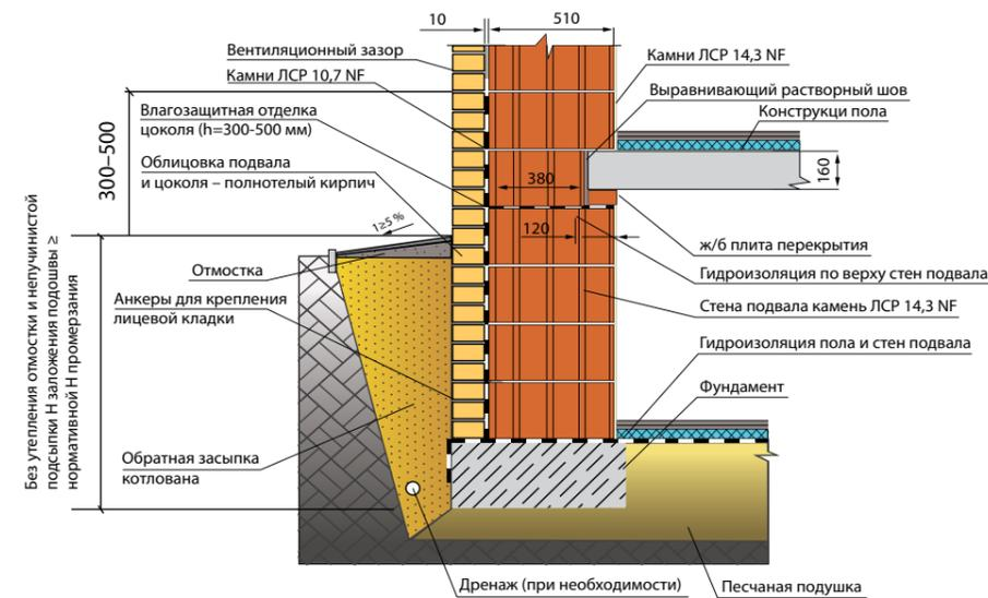
Наружная стена подвала из крупноформатных камней ЛСР 14,3 НФ (510 мм), монолитное ж/б перекрытие, наружная стена из крупноформатных камней ЛСР 14,3 НФ (510 мм) облицовкой кирпичом ЛСР (120 мм)
