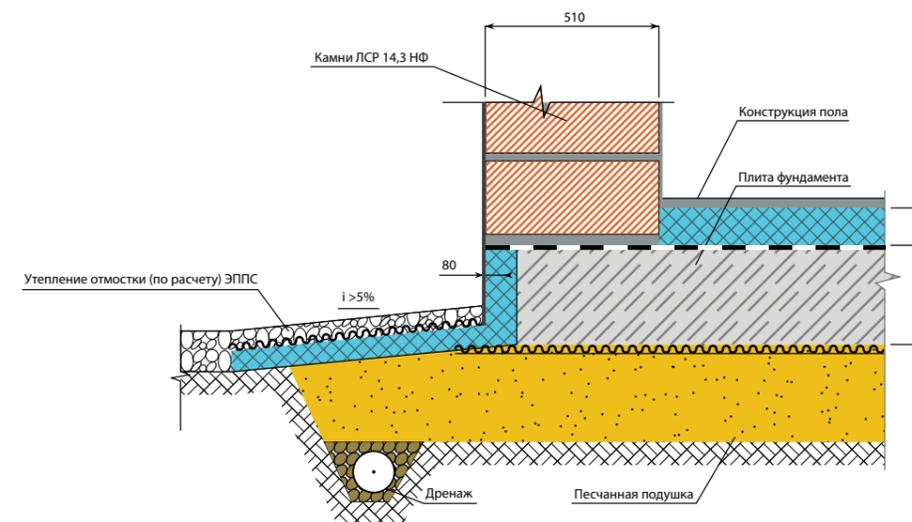
Мелкозаглубленный утепленный фундамент отапливаемого дома в виде ребристой плиты, стена из крупноформатных камней ЛСР 14,3 НФ (510 мм) с облицовкой с наружной штукатуркой
