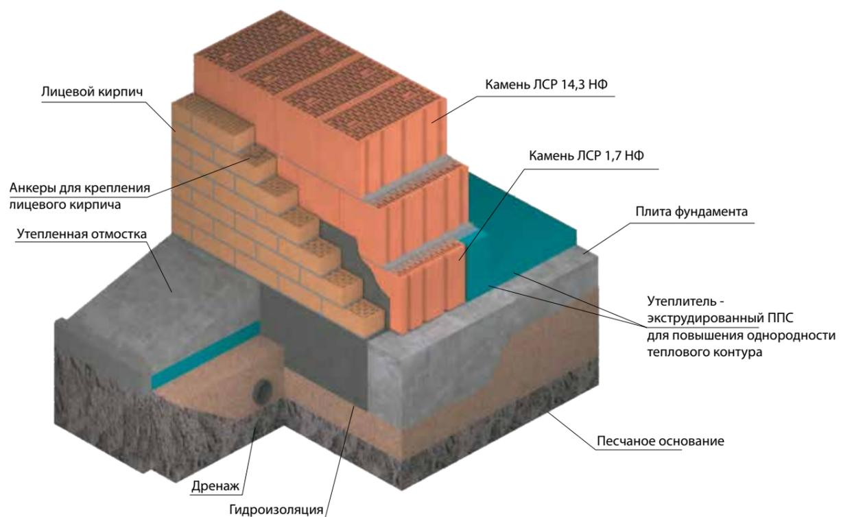
Мелкозаглубленный фундамент отапливаемого дома в виде ребристой плиты. Стена из крупноформатных камней ЛСР 14,3 НФ (510 мм) с облицовкой кирпичом ЛСР (120 мм)
