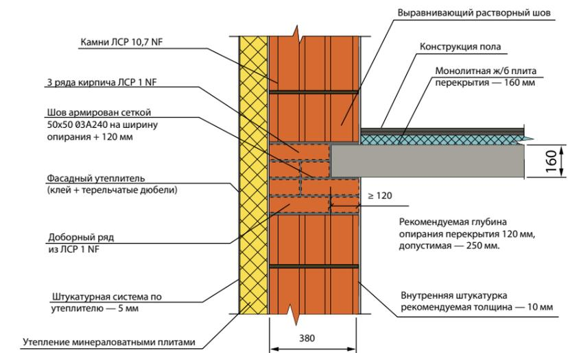
Монолитное ж/б перекрытие, наружная стена из крупноформатных камней ЛСР 10,7 НФ (380 мм) с утеплением и наружной штукатуркой
