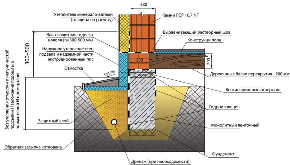
Монолитный ленточный фундамент, перекрытие по деревянным балкам, наружная стена из крупноформатных камней ЛСР 10,7 НФ (380 мм) с утеплением и наружной штукатуркой
