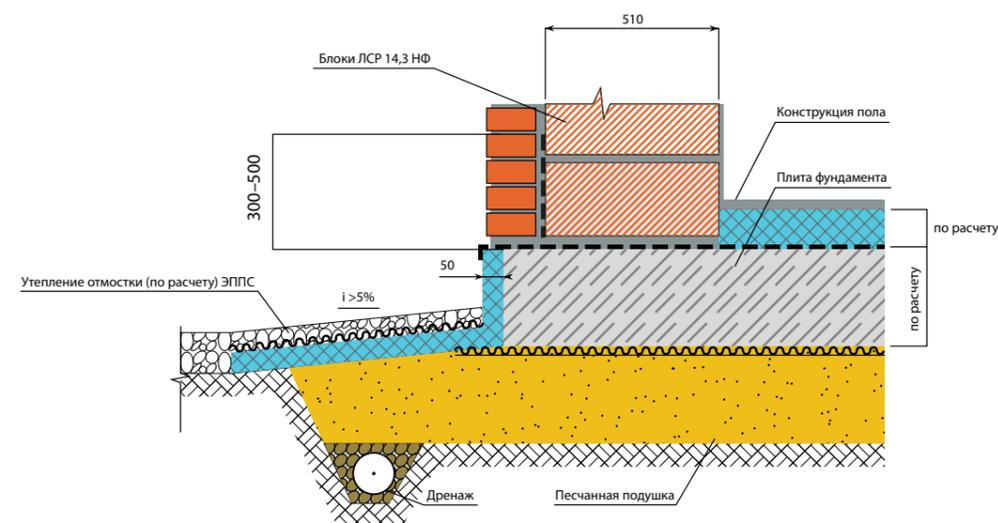
Мелкозаглубленный фундамент отапливаемого дома в виде плиты, стена из крупноформатных камней ЛСР 14,3 НФ (510 мм) с облицовкой кирпичом ДСР (120 мм)
