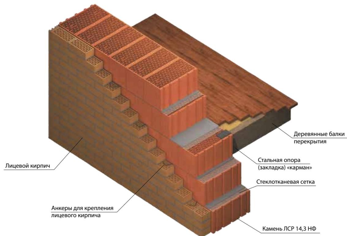
Опираие деревянных балок перекрытия на стену из крупноформатных камней ЛСР 14,3 НФ (510 мм) с облицовкой кирпичом ЛСР (120 мм)
