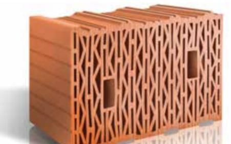
Поризованный камень 10,7 НФ тёплый является основным камнем при возведении несущих, самонесущих наружных стеновых конструкций толщиной 380 мм с термическим сопротивлением не менее 3,7 м<sup>2</sup>°C/Вт.
