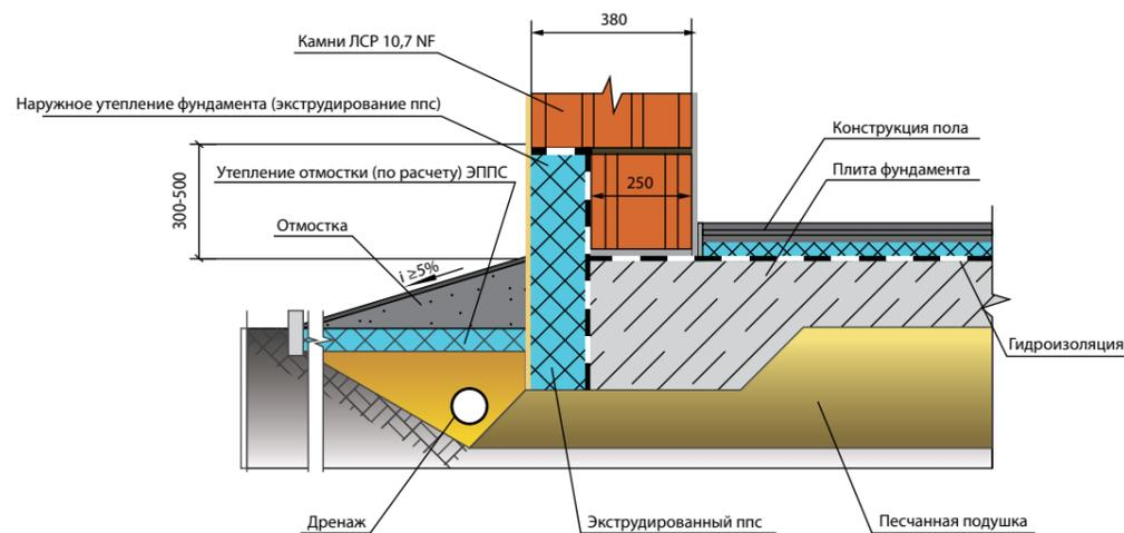
Мелкозаглубленный утепленный фундамент отапливаемого дома в виде ребристой плиты, стена из крупноформатных камней ЛСР 10,7 НФ (380 мм)
