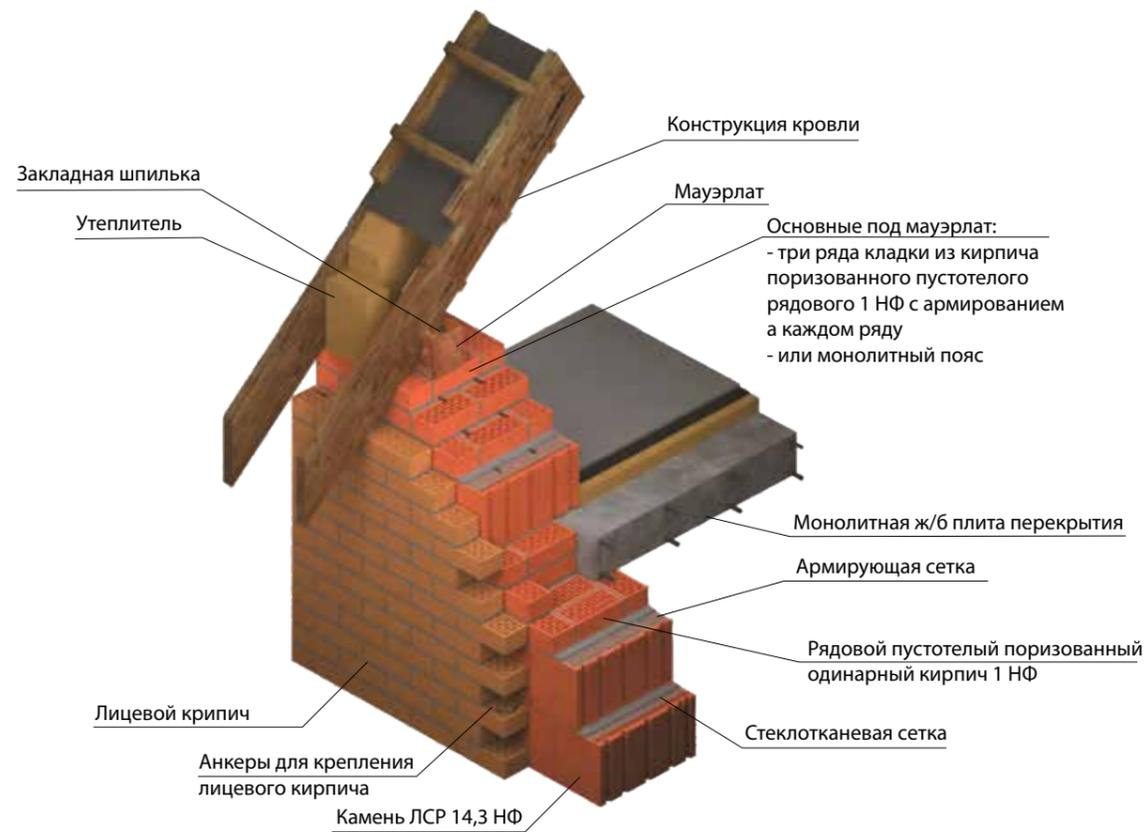
Устройство скатной крыши. Стена из крупноформатных камней ЛСР 14,3 НФ (510 мм) с облицовкой кирпичом ЛСР (120 мм)
