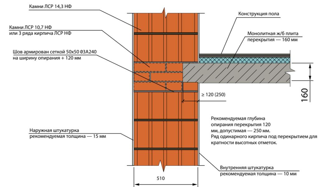
Монолитное железобетонное перекрытие, наружная стена из камней ЛСР 14,3 НФ (510 мм) с наружной штукатуркой
