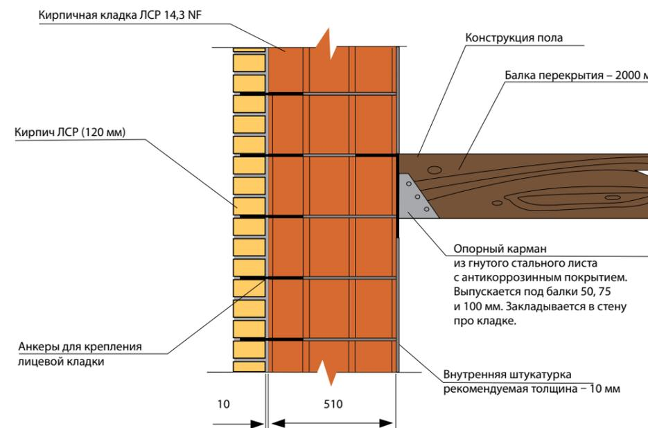
Перекрытие по деревянным балкам с опорой в стальной «карман», наружная стена из крупноформатных камней ЛСР 14,3 НФ (510 мм) с облицовкой кирпичом ЛСР (120 мм)
