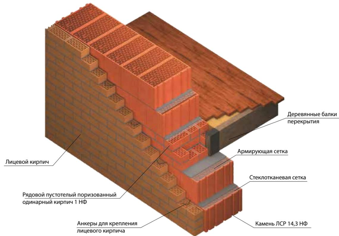
Опирание деревянных балок перекрытия на стену из крупноформатных камней ЛСР 14,3 НФ (510 мм) с облицовкой кирпичом ЛСР (120 мм)
