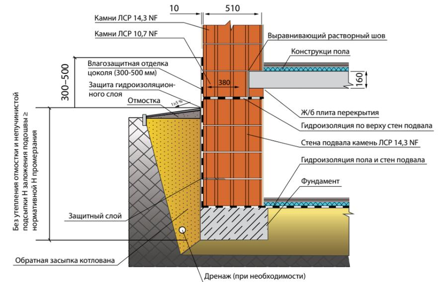
Наружная стена подвала из крупноформатных камней ЛСР 14,3 НФ (510 мм), монолитное ж/б перекрытие, наружная стена из крупноформатных камней ЛСР 14,3 НФ (510 мм) с наружной штукатуркой
