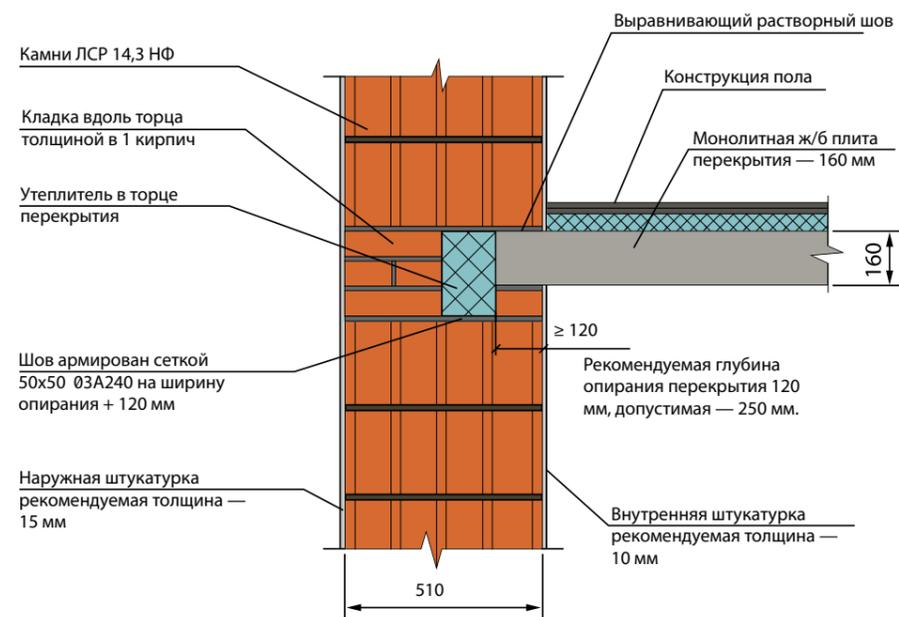
Вариант исполнения торца железобетонного перекрытия, наружная стена из крупноформатных камней ЛСР 14,3 НФ (510 мм).
