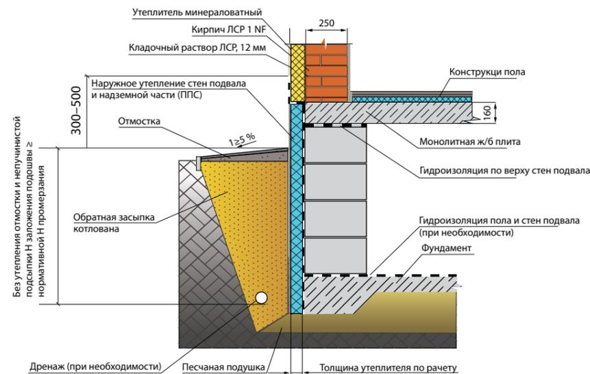
ЛСР 10,7 НФ (380 мм) с утеплением и облицовкой кирпичом ЛСР (120 мм) Наружная стена подвала из бетонных блоков, монолитное ж/б перекрытие, наружная стена из крупноформатных камней ЛСР 1НФ (250 мм) с наружным утеплением и штукатуркой
