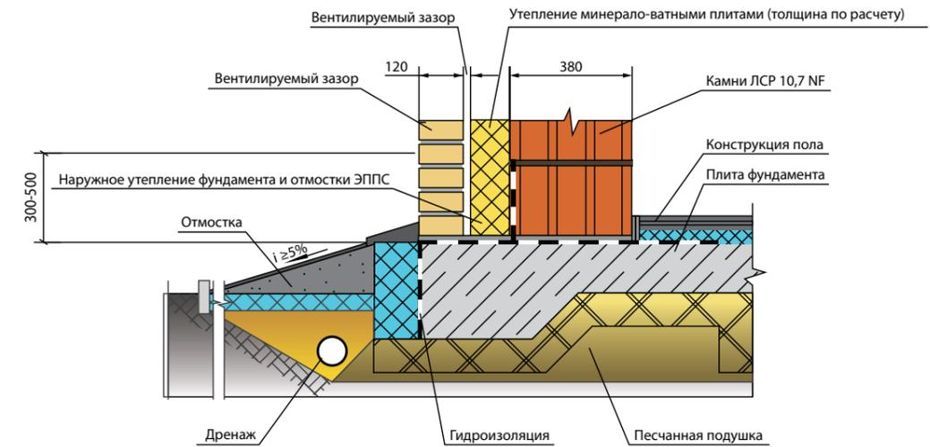
Мелкозаглубленный фундамент отапливаемого дома в виде ребристой плиты, стена из крупноформатных камней ЛСР 10,7 НФ (380 мм) с утеплением и облицовкой кирпичом ЛСР (120 мм)
