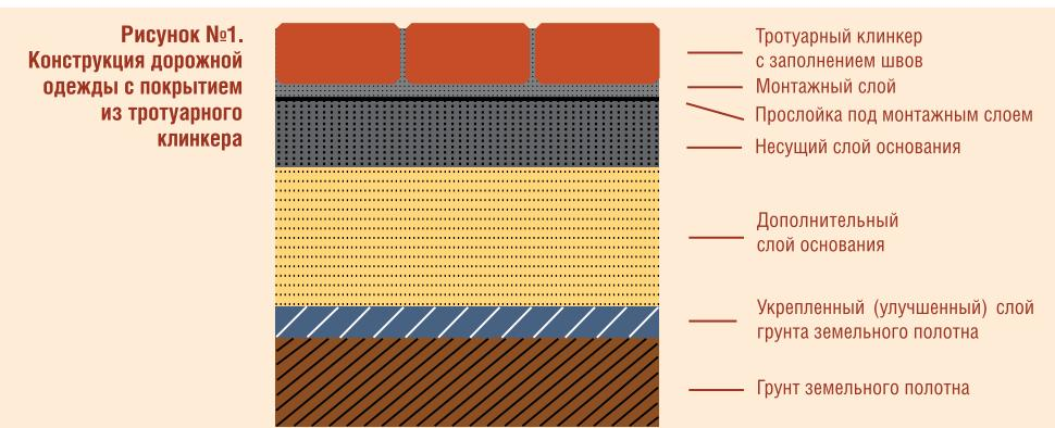
**Несущее основание** – часть дорожной одежды, обеспечивающая совместно с покрытием перераспределение и снижение давления на нижележащие дополнительные слои или грунт земельного полотна. Основание может быть выполнено из различных материалов: щебня, укладываемого с расклинкой; песко-цементной смеси; щебня, укрепленного цементом или расклинцованным песко-цементной смесью или других материалов, модуль упругости которых превышает 180 МПа.
