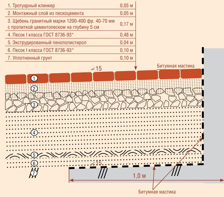
Гидроизоляция подземных частей зданий выполняется, как показано на рис. 4. Уплотненному дну котлована придается уклон от стен здания к фундаменту, приклеивается рулонная вертикальная гидроизоляция, которая заводится на 1-1,5 м на дно котлована, а поверх устраивается основание под мощение. Таким образом, вода, дренирующая через подстилающие слои песка и щебня отводится от фундамента.
