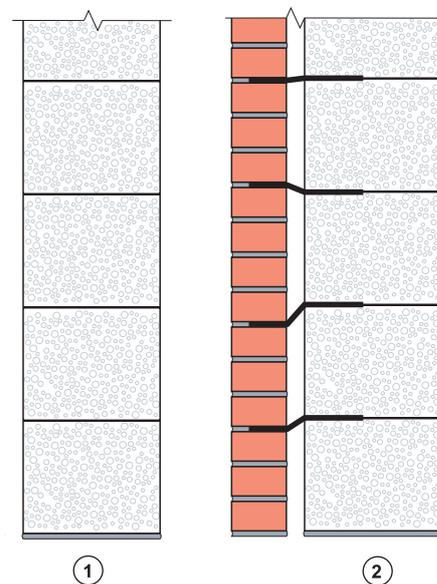
Рис. 4.3. Схемы стен из блоков ЛСР:
