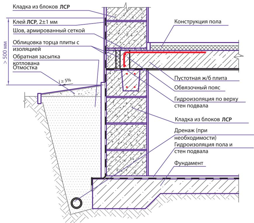
**Наружная стена подвала из блоков ЛСР с перекрытием из ж/б плит**
