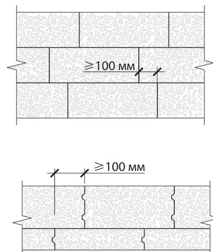
Рис. 4.4. Перевязка кладки
