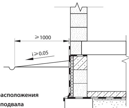
Рис. 4.2. Схема расположения гидроизоляции подвала
