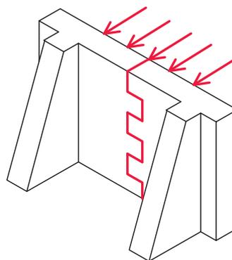
**Рис. 3.3.** Растяжение кладки при изгибе по перевязанному сечению
